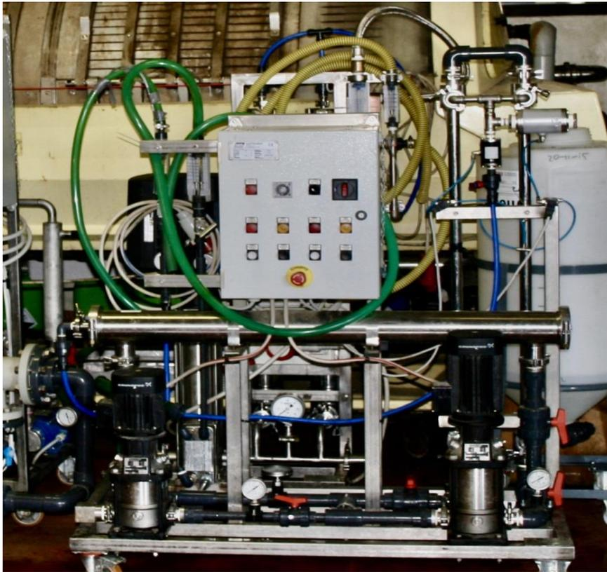
Figura 4. *Impianto pilota di ultrafiltrazione tangenziale*
