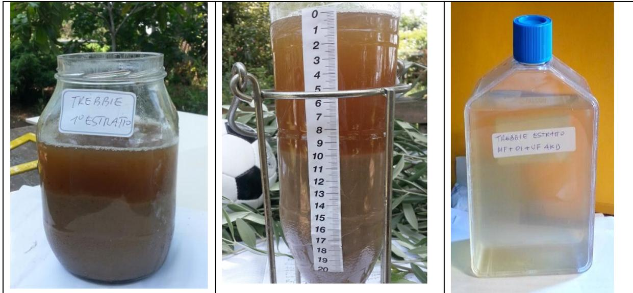
Figura 3: fasi di trattamento delle trebbie (primo estratto; sedimentato; permeato di ultrafiltrazione).
