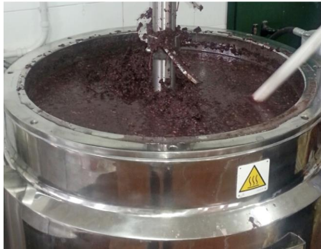
Figura 6: estrattore di principi attivi da vinacce di sagrantino.
