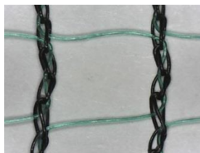
TELAI RASCHEL MONOFILO: produzione di tessuti in monofilo a maglia annodata
