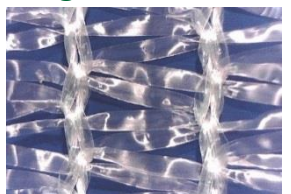
TELAI RASCHEL ISO: produzione di tessuti in bandella a maglia annodata
