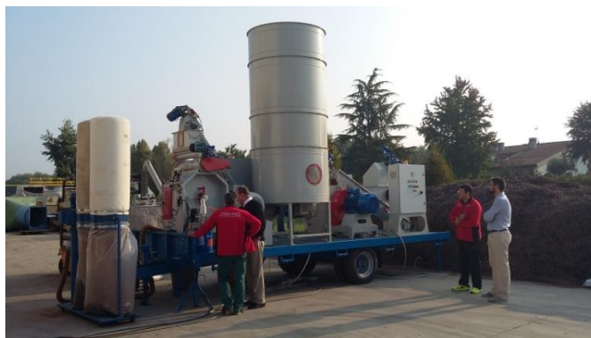
Filiera Agripellet da potature con cantiere mobile di pellettizzazione (Febbraio- Settembre 2016)
