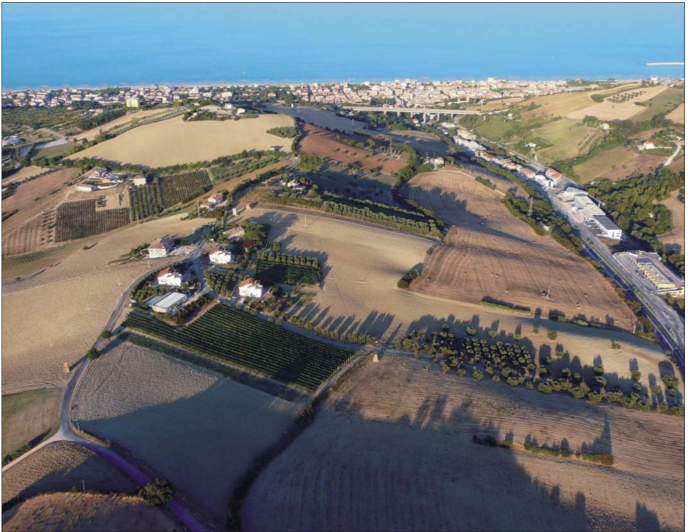
Figura 3 – Esempio di sistemazione a rittochino dei versanti collinari costituiti da depositi argilloso-sabbiosi plio-pleistocenici nelle Marche meridionali (Foto Meconi)
